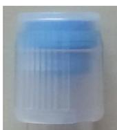
La limite optimale des 100% de remplissage est indiquée sur ce tube par un double trait opaque
